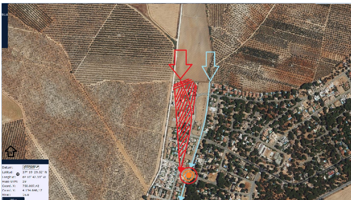
Figura 6. Recorrido del agua hasta su canalización definitiva a través del canal (punto de encuentro puente de la calle Acebuche sobre canal). Fuente de la ortofoto: I.G.N. Año 2019.
