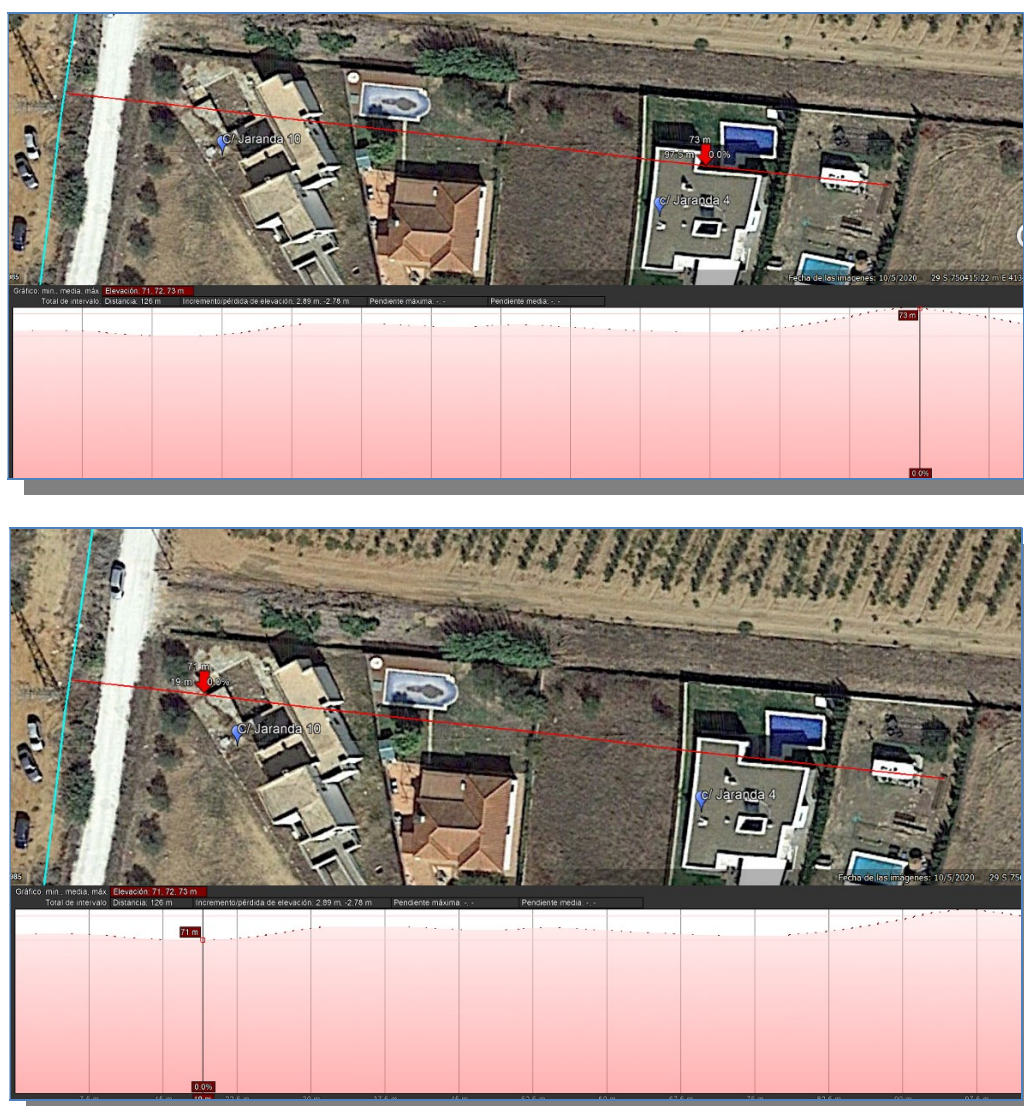
Figura 32. Perfil longitudinal del terreno en las parcelas situadas al norte de la urbanización La Juliana. La cota de la parcela de la dirección c/ Jaranda 4 es la 73 y la cota de la parcela de la dirección c/ Jaranda 10 más occidental es la 71
